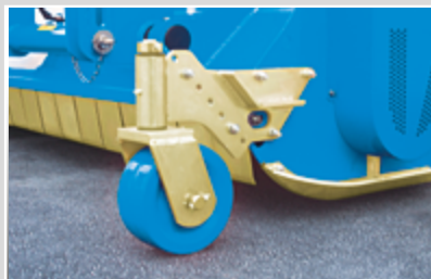
Ruote anteriori pivotanti in ferro per una migliore uniformità di taglio (opzionale).
