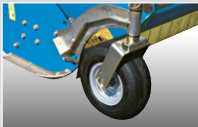
Ruote anteriori pivotanti in gomma per una migliore uniformità di taglio (opzionale).
