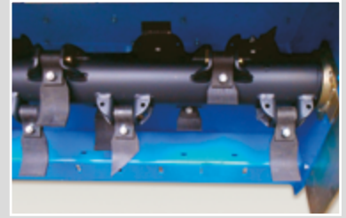
Rotore per patate con coltelli tipo 09 Rotor to shred potato haulms with 09 type knives
